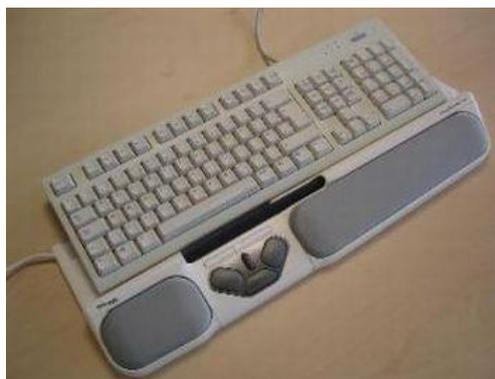
**Descripción:** Reposamuñecas para teclado de computadora, con dispositivo de entrada óptica integrado.
